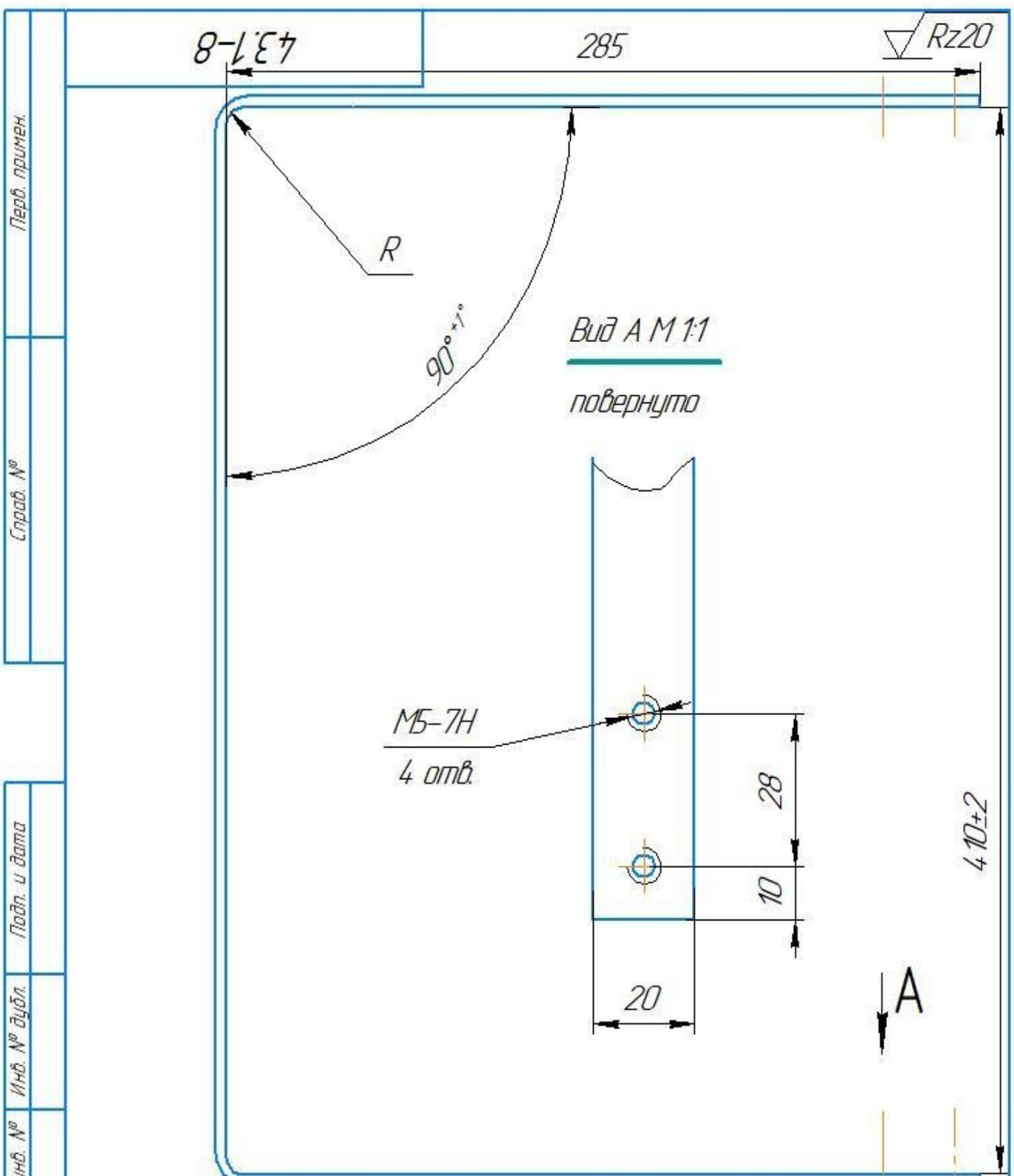
1. Неуказанные предельные отклонения размеров охватываемых поверхностей  $h12$ , охватывающих поверхности  $H12$ , прочих  $\pm T12/2$ .
