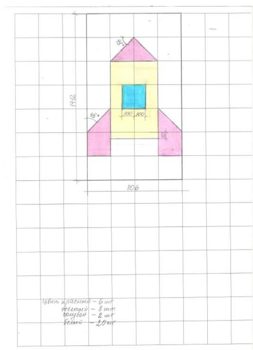
Длина облицовываемой поверхности стены – 806 мм.
